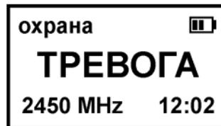
Следующий звуковой сигнал тревоги появляется не ранее чем через пять минут и только для нового опасного сигнала. Вибросигнал при состоянии тревоги повторяется каждые пять минут. Кроме того, текущее состояние можно определить по частоте мигания светодиода: редкое мигание – норма, частое – тревога.
