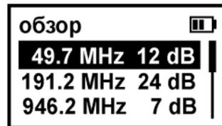
В случае пропадания сигнал удаляется из списка не сразу, а с задержкой примерно 10 секунд, в это время на дисплее отображается последнее ненулевое значение уровня сигнала.
