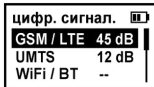
В режиме мониторинга цифровых сигналов на дисплее отображается список всех цифровых сигналов и их обнаруженные уровни. Для перемещения по списку используйте кнопки ▲ или ▼. Для мониторинга только одного выбранного сигнала нажмите кнопку **[OK]**. Для возврата к списку нажмите на кнопку **[OK]** или **[C]**.
